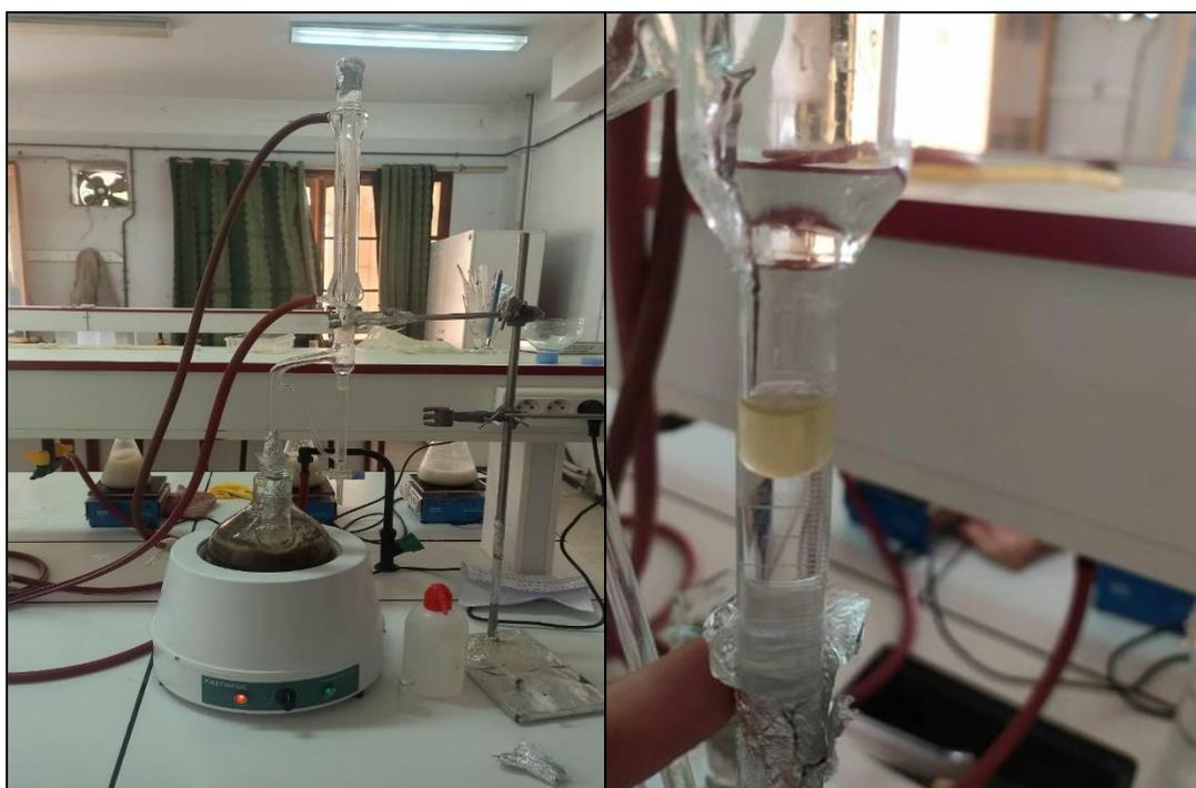
*Figure 9 : Montage d'Hydrodistillation de type Clevenger dans le laboratoire*
