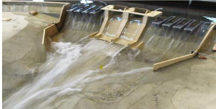
Photo N° 06 : Aménagement de seuils en touche de piano sur l'évacuateur existant du barrage de Charmine (France, 01)
