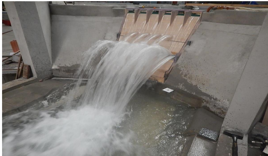
Photo N° 07 : Optimisation de la dissipation d'énergie en pied de l'évacuateur de crues du barrage de Janneh (Liban)
