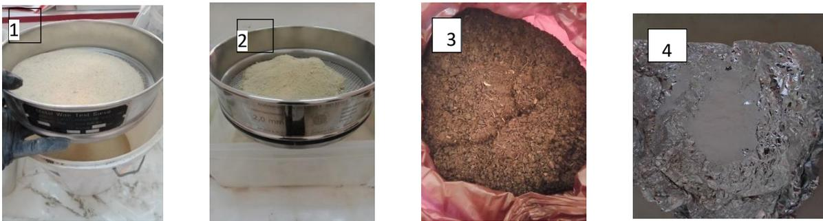
**Figure 21.** Constituants du sol artificiel : (1) sable (2) argile (3) tourbe (4) carbonate de calcium CaCO<sub>3</sub> (photos personnelles 2024).
