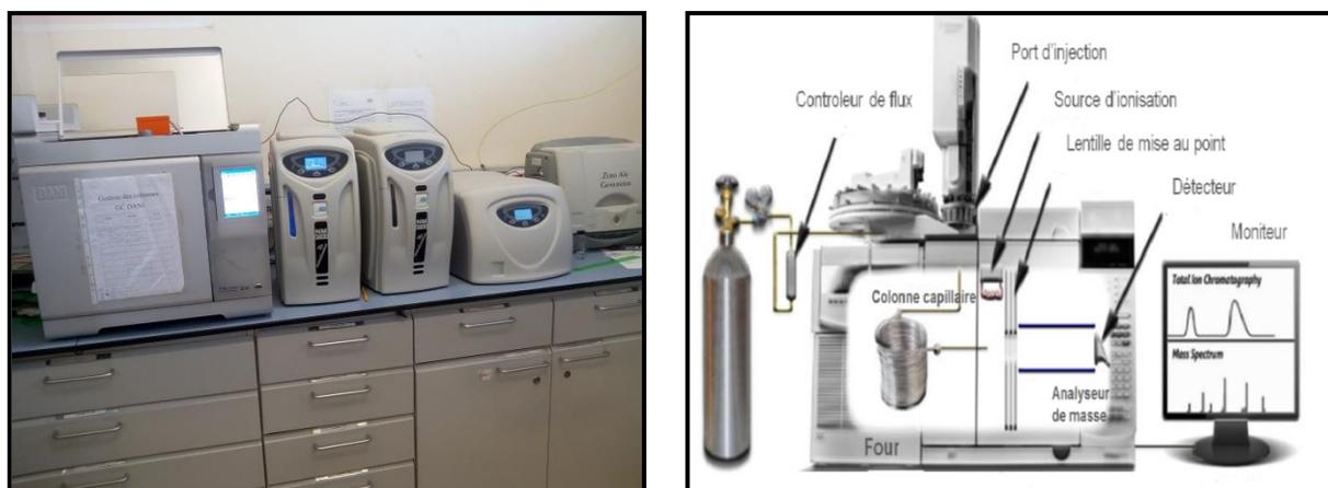
**Figure 4.** Chromatographie en phase gazeuse couplée à la spectrométrie de masse (CPG/SM).
