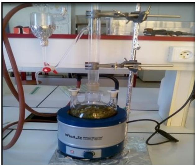
**Figure 3.** Montage de l'hydrodistillateur (photo personnelle).
