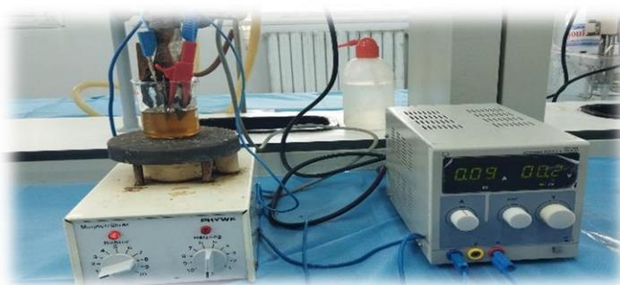
Figure II. 9 : Dispositif d'électrodeposition.
