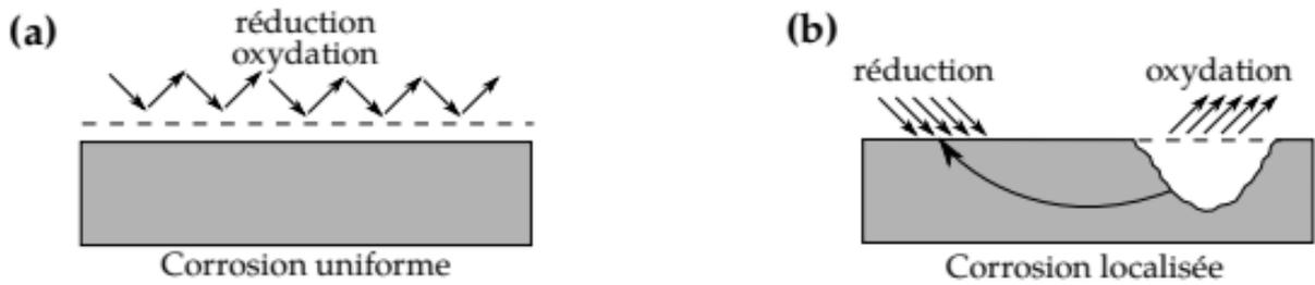
Figure I. 3 : (a) Corrosion uniforme, (b) Corrosion localisée.
