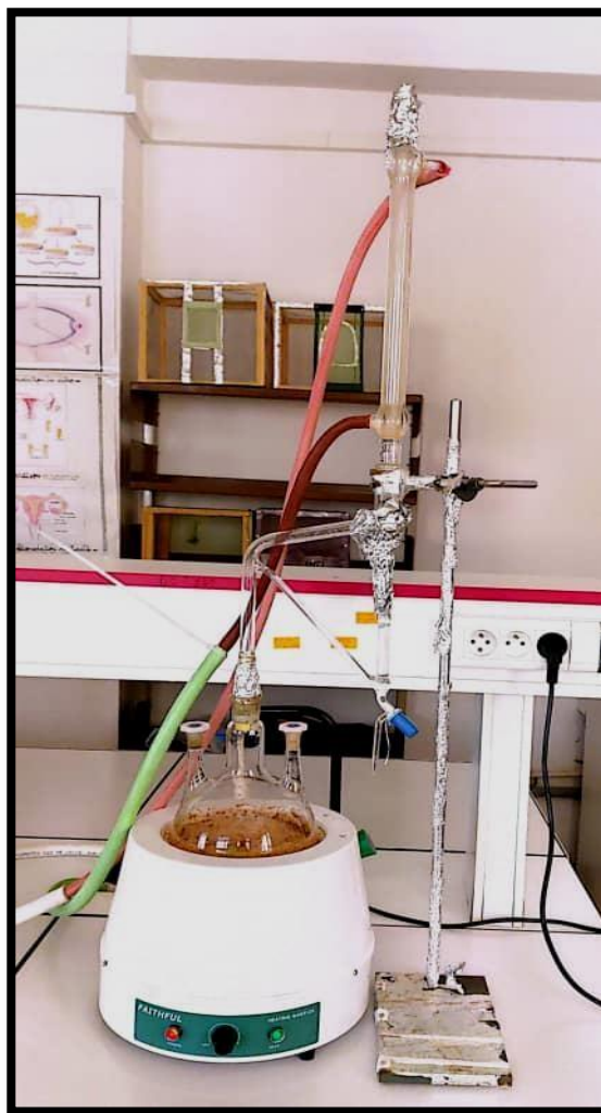
Figure 11: L'appareil d'extraction de l'huile essentielle (CLEVINGER).
