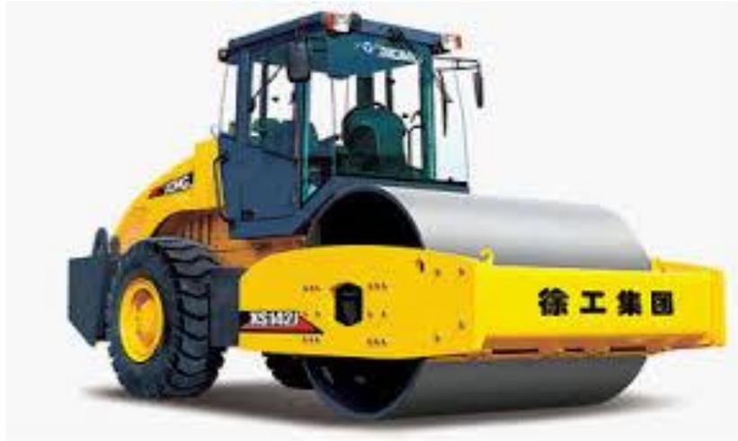
**Fig. 20** Les rouleaux compresseurs
