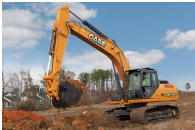
**Fig. 6** engins de terrassement type pelle montés sur chenilles
