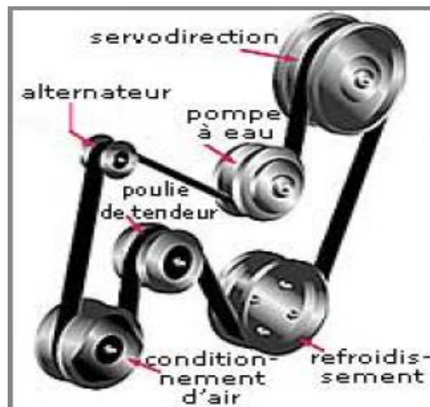
Fig. 3.2 : Transmission par chaîne et courroie
