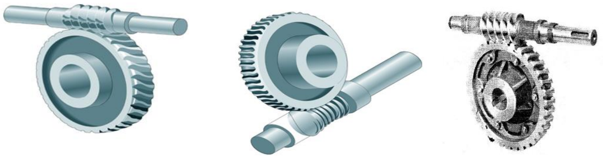
Fig.1 ; 23 : Roue avec Vis sans fin
