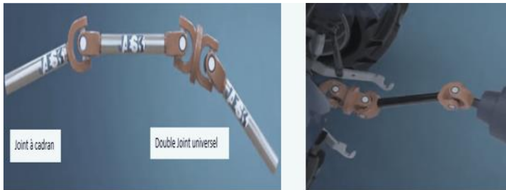
Fig. 5.8 : double Joint à Cardan monté sur un remorque
