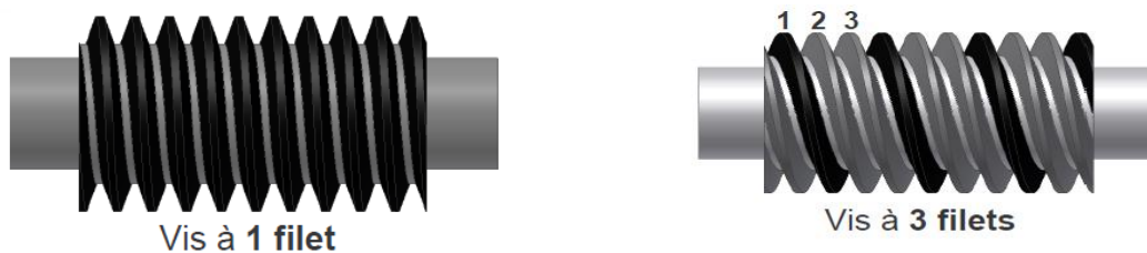
Fig. 1.30 : Vis à 1 et 3 filets
