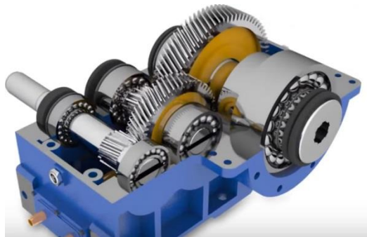
Fig. 4.1 : Réducteurs à trains d'engrenage à axes parallèles
