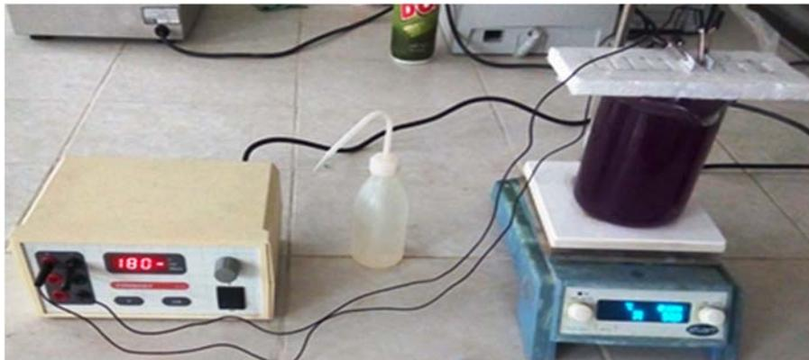
Photo 01: Installation d'électrocoagulation utilisée
