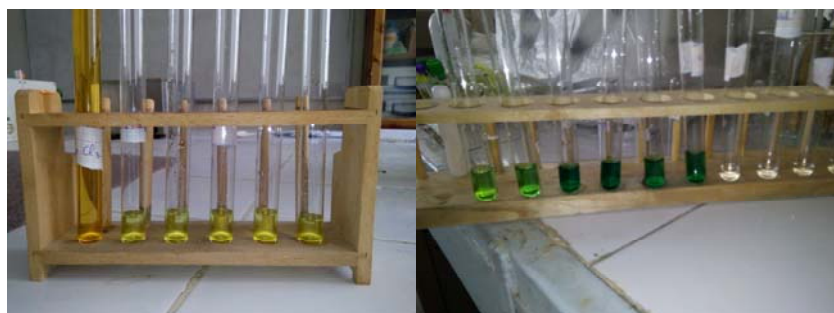
Figure II.9 : Réduction du fer ferrique en fer ferreux.
