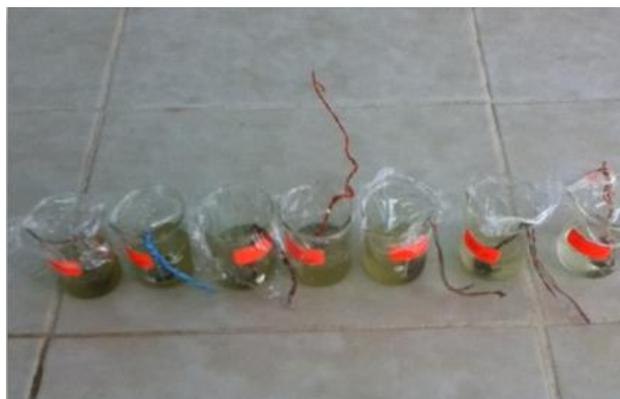
**Figure 11 :** Les échantillons en acier API 5L-X60 trempés dans une solution HCl 1N, sans et avec l'ajout de différentes concentrations de l'extrait de la plante *Echium italicum L.*
