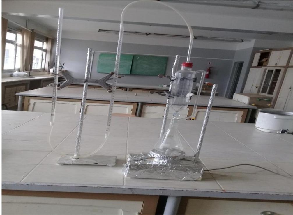
**Figure 14 :** l'appareillage de dosage du calcaire
