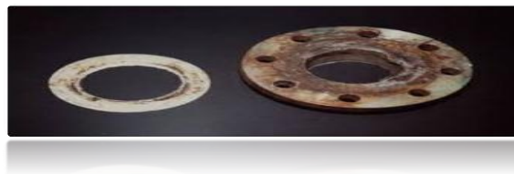
Figure I. 5: La corrosion par crevasse
