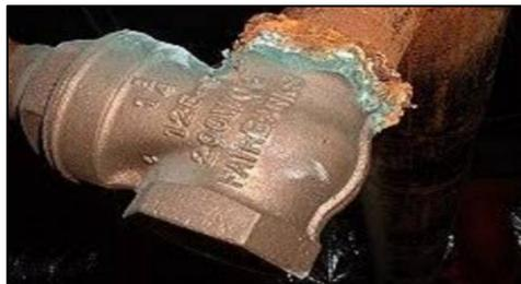
**Figure I.2** La corrosion galvanique
