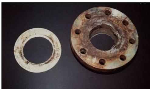
**Figure I.3** La corrosion caverneuse
