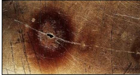
**Figure I.1** La corrosion par piqure.
