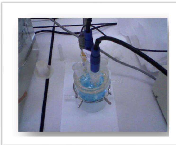
**Figure.12** : cellule utilisée pour les mesures électrochimiques (voltammétrie)
