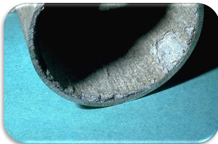
Figure 3 : Structure métallurgique touchée par la corrosion inter-granulaire
