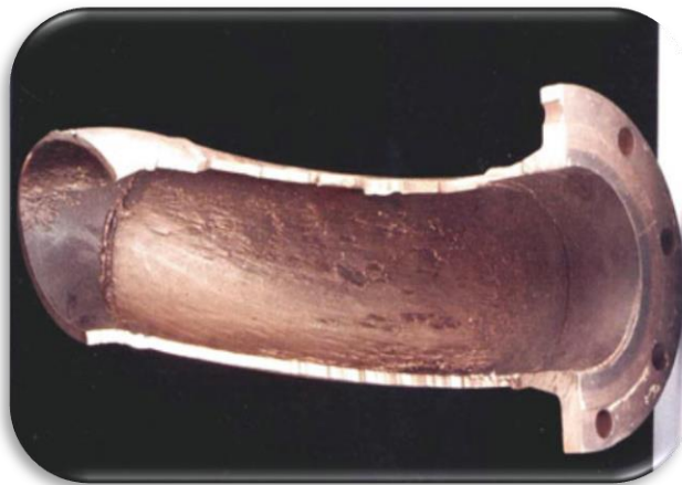
Figure 6 : Corrosion par érosion sur un acier au carbone
