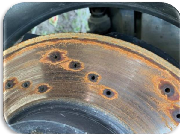
Figure 8 : Corrosion par frottement d'un frein de disque
