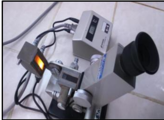
Figure 24 : Refractomètre d'Abbe avec contrôleur de température
