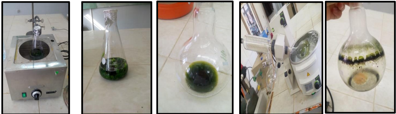
Figure 23 : Technique de macération (feuilles de céleri) avec éthanol.
