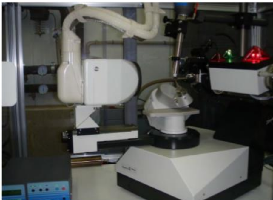
Figure.I.10. Diffractomètre automatique à quatre cercles Kappa CCD de Brüker-Nonius. [17]
