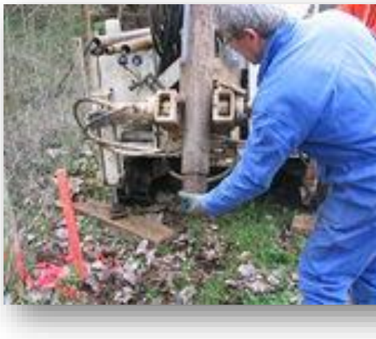
Photo 6 : Prélèvement et récupération des carottes
