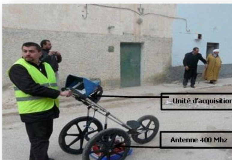
Figure 47 : Montage de l'antenne 400 MHz
