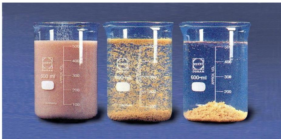
**Photo 2 :** Exemple d'un traitement d'une eau résiduaire par coagulation-floculation.
