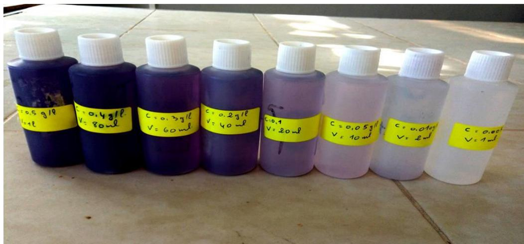
**Photo 11 :** Solutions préparées pour la courbe d'étalonnage.
