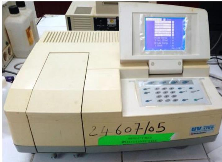
**Photo 10 :** Spectrophotomètre SHIMADZU UV-1700PC.
