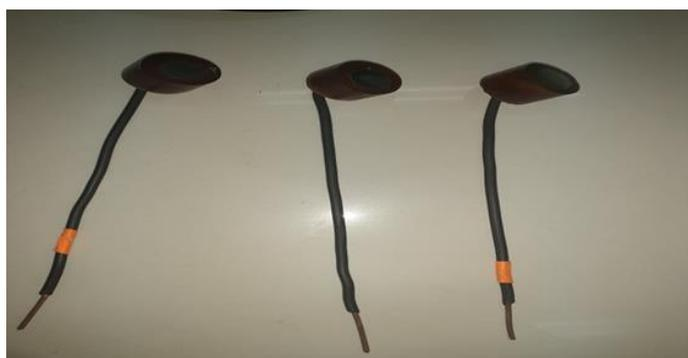
**Figure 32** : Les électrodes de travail.
