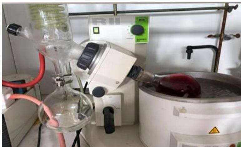
**Figure 23 :** Montage d'évaporation.
