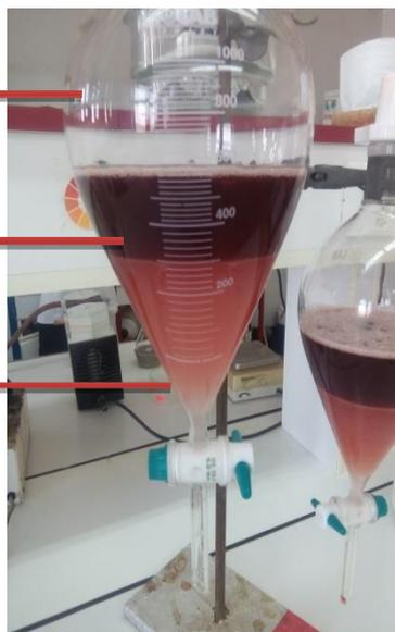
**Figure 24:** Montage de dispositif d'extraction liquide –liquide.
