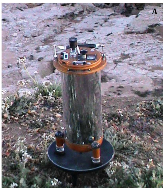
Figure 24 : Mise en œuvre d'une prospection microgravimétrie et levés topographiques sur le terrain. (MChentel- Chéria)
