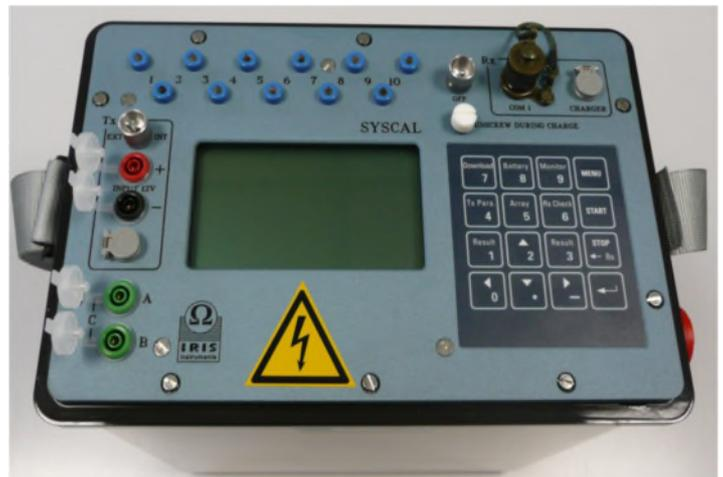
**Fig.59.a** Matériel d'acquisition multi-électrodes. **Fig.59.b** résistivimètre syscal de IRIS instrument.
