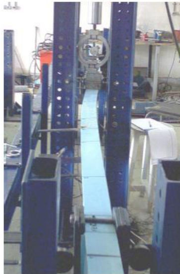
Fig. III. 6. Déformée hors plan d'une poutre cellulaire après déversement [7]
