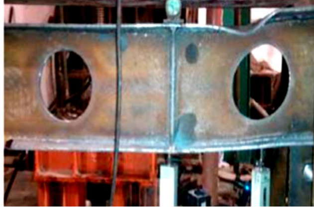
Fig. III. 21. Voilement locale de la semelle supérieure d'une poutre testée [19]
