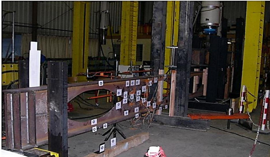
Fig. III. 14. Dispositif d'essai et de mesure utilisé par Durif et al [13]
