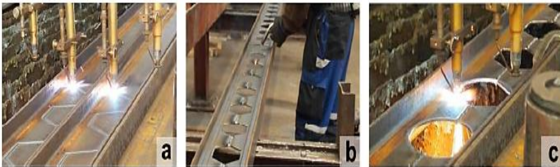
Fig. III. 16. Processus de fabrication différent des poutres cellulaires [16]
