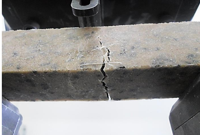
Figure XII-22 Rupture et arrachement des fibres de verre
