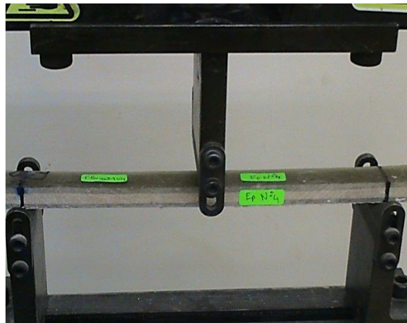
Figure III-19 La mise en œuvre de la flexion trois points des éprouvettes de BPRES
