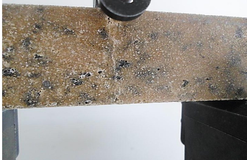
Figure II-18 Amorçage de la fissuration dans la zone tendue des éprouvettes
