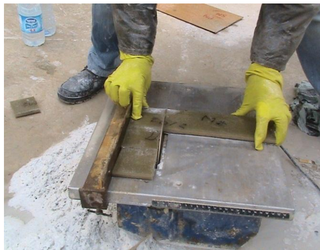
Figure III-7 Découpage des plaques composites à l'aide de la scie diamantée
