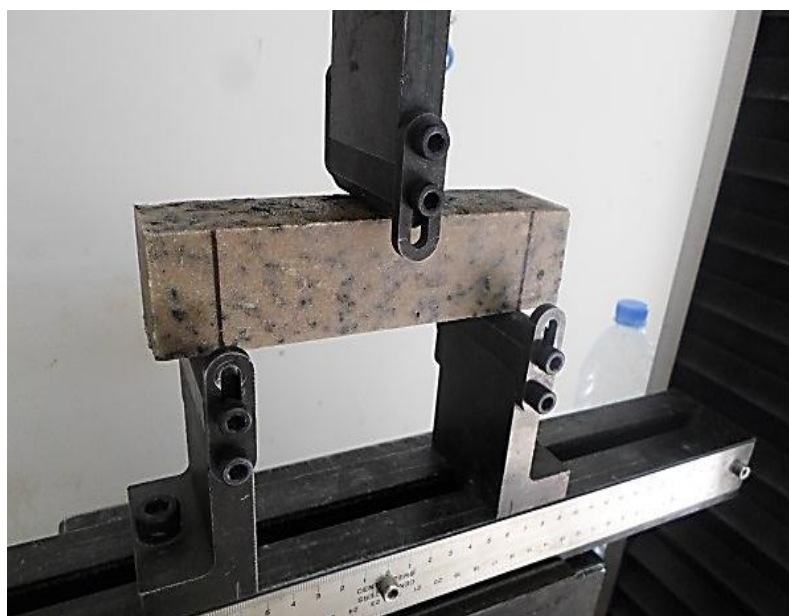
Figure II-16 Epreuve de béton polymère soumise à la flexion trois points
