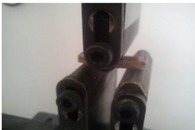
Figure III-12 Montage de l'essai de cisaillement interlaminaire
