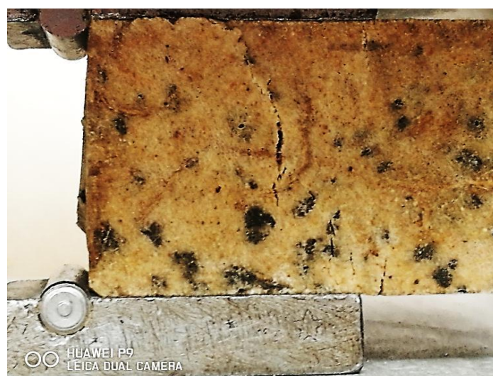
Figure XII-28b Pontage des fissures par les fibres courtes de jute
