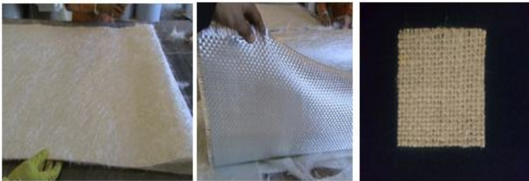
Figure III-3 Les trois types de renforts utilisés pour la confection des stratifiés (a) Tissu mat quasi-isotrope (b) Tissu de verre 2D (3) Tissu 2D de jute
