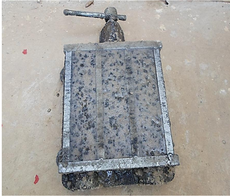
Figure II-8 Les éprouvettes du béton polymère dans le moule pendant la polymérisation
