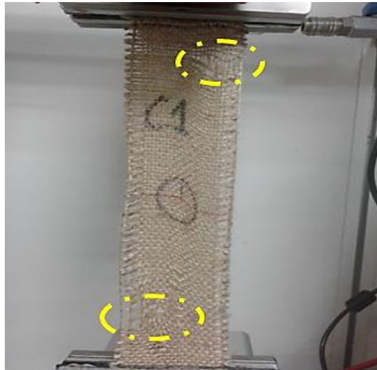
Figure I-9 La rupture des tissus de jute au voisinage des mâchoires
