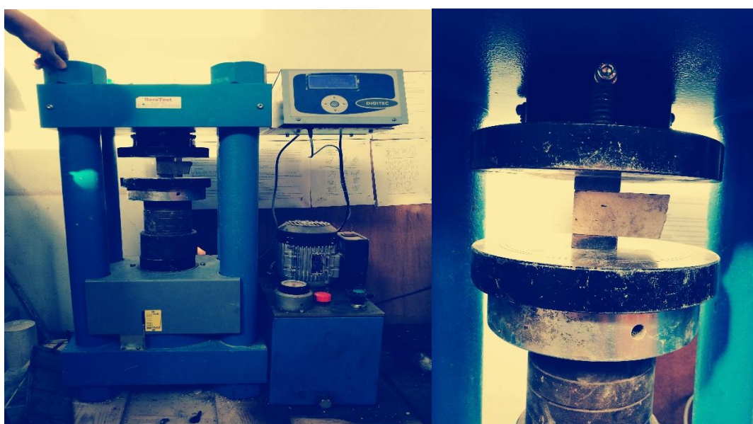
Figure XII-25 La Machine et le dispositif de l'essai de compression
