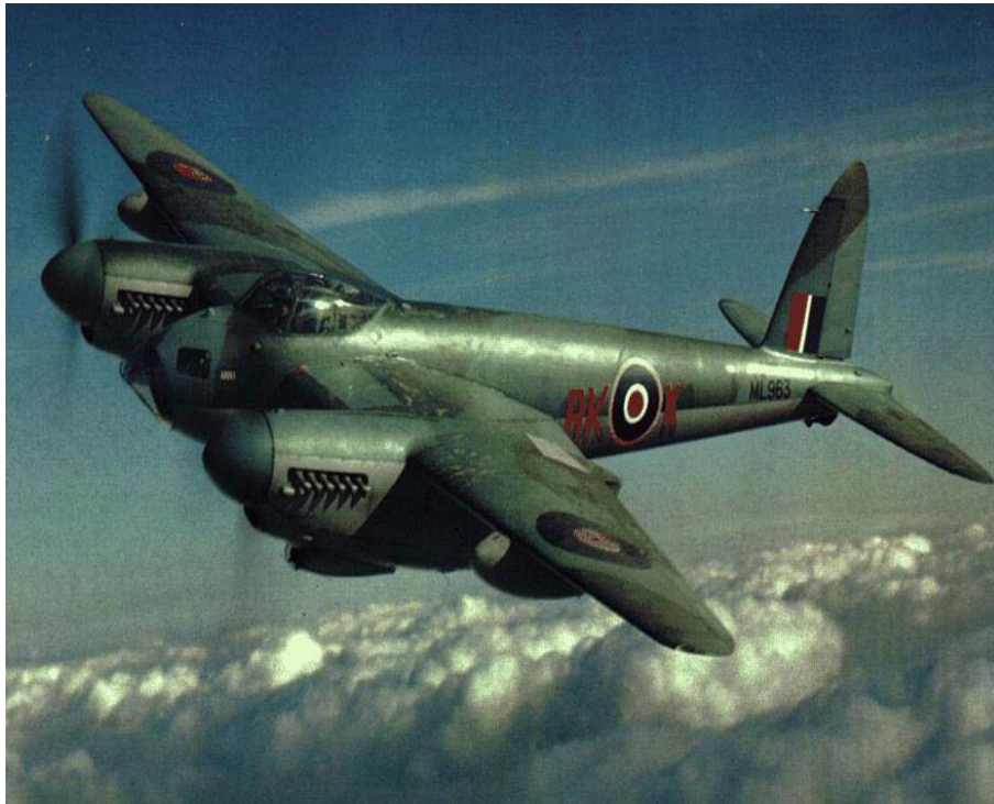
Figure 1.6 L'avion militaire Britannique; le Mosquito, en structure sandwich [5].
