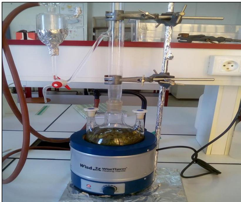
**Figure 8.**Montage de l'hydrodistillateur (photo personnelle, 2018).
