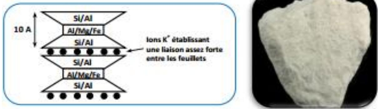
Figure –I-3- Structure élémentaire de la Montmorillonite (Mazouz 2010).
