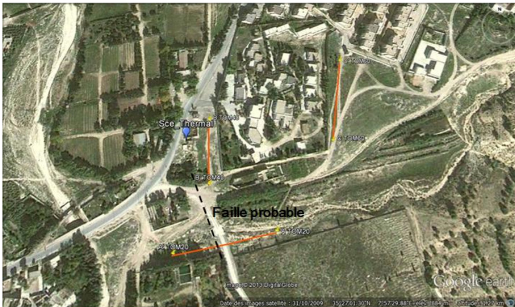
Figure 37: Localisation des profils de tomographie électriques. (Coté de la source thermale de Youkous)[ZAROUKKI, H. 2013].
