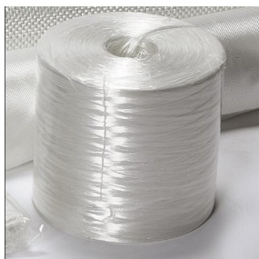
Fig. 2.2 Bobinage des fibres de verre
