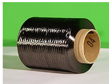
Fig. 2.3 Bobinage des fibres de carbone
