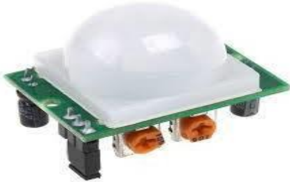
Figure 18 : Capteur de mouvements PIR
