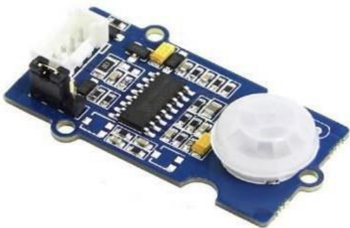
Figure 19 : Capteur de mouvement PIR GROVE
