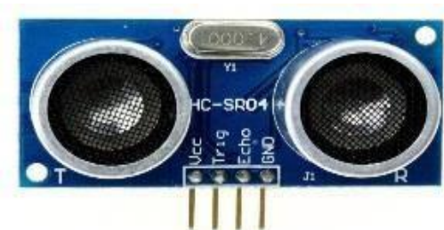
Figure 20 : Capteur de distance ultrason HC-SR04
