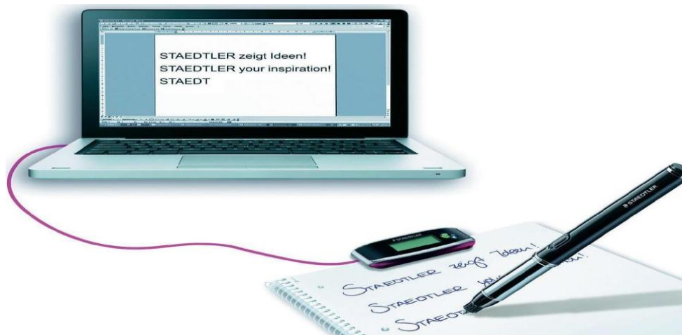
Figure 1 : Exemple d'un système de reconnaissance en ligne cas du stylo numérique
