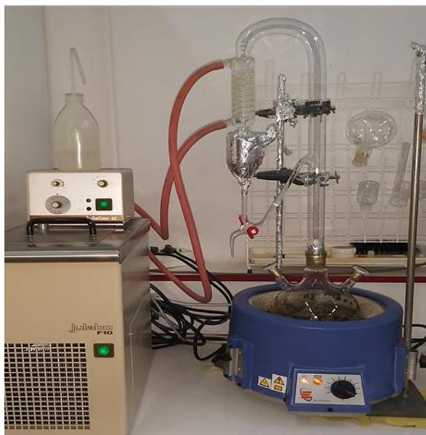
**Figure 12** : Le dispositif d'extraction type Clevenger
