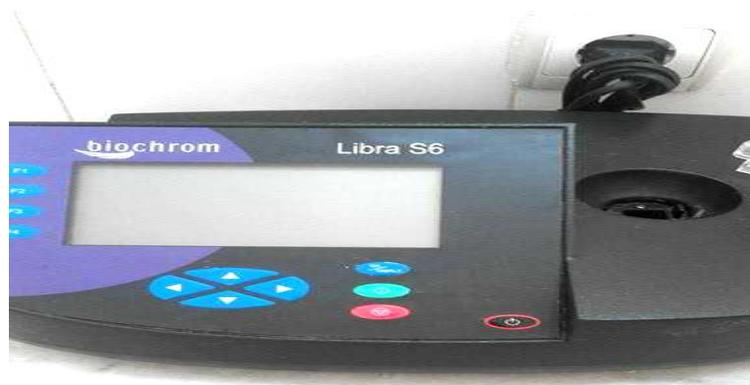
**Figure 07: Spectrophotomètre numérique de marque BIOCHROME LIBRA S6 (photo personnelle).**
