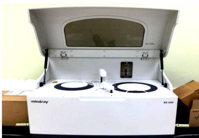
Figure 14. automate pour dosage des paramètres biochimique (mindray BS-200)
