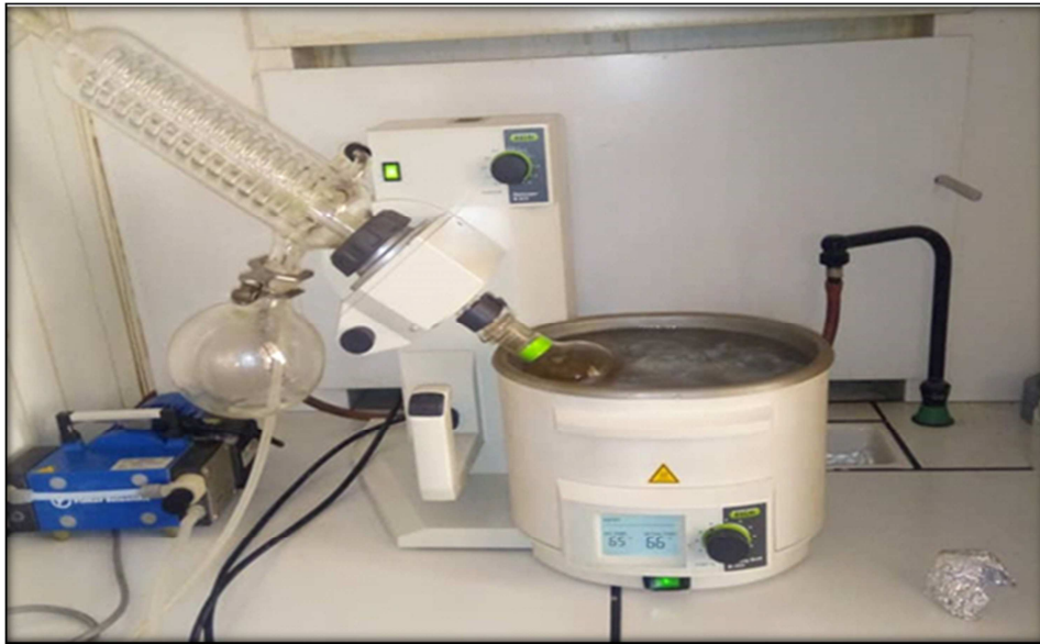
Figure (8) : concentration de l'extrait à l'évaporateur rotatif (Photos personnelles).
