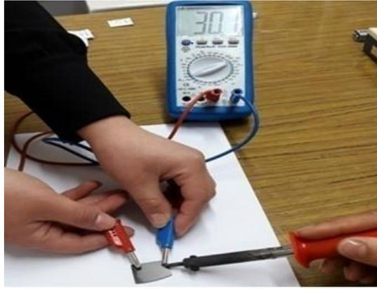
**Figure III.8.** Exemple de principe de la technique de la pointe chaude.
