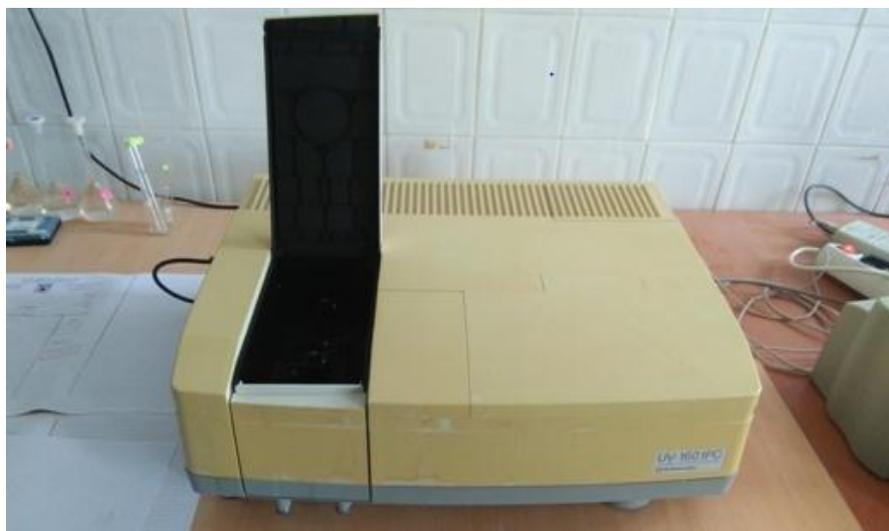
**Figure II.11.** Dispositif expérimental de la spectroscopie UV-Vis-NIR.
