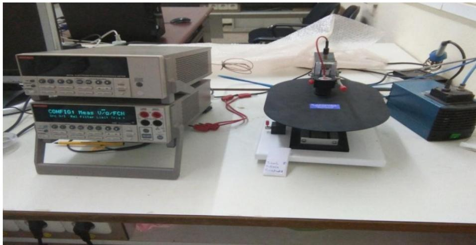
**Figure II.18.** Dispositif quatre points, modèle KEITHLEY 617.
