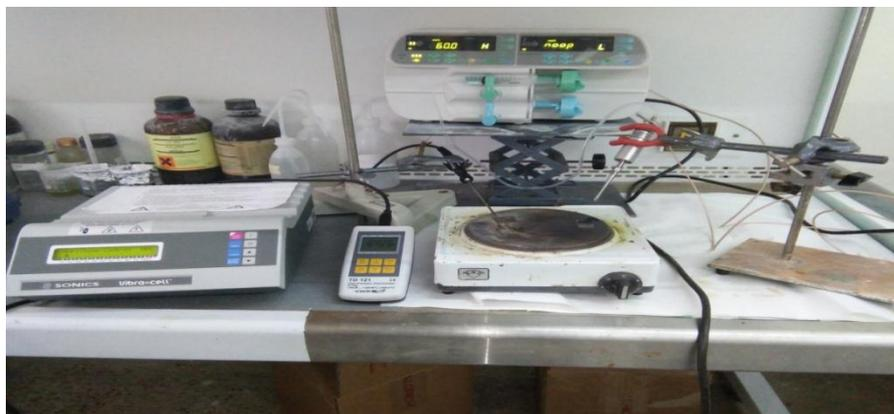
**Figure II.3.** Dispositif expérimentale complet de la technique de spray pyrolyse ultrasonique.
