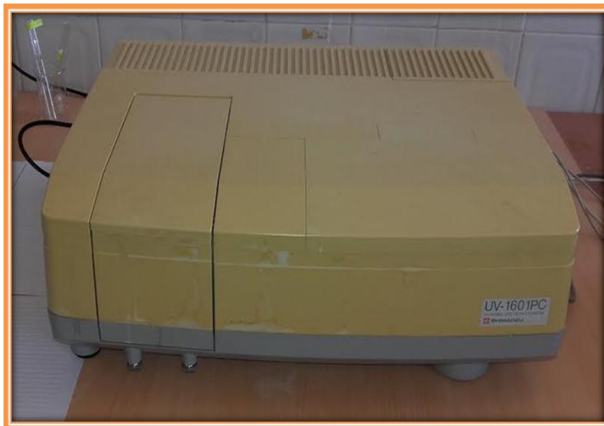
Figure II.9 : Dispositif expérimental de la spectroscopie UV-visible utilisé (Laboratoire des matériaux organiques et hétérochimie .Université Larbi Tébessi.Tébessa).
