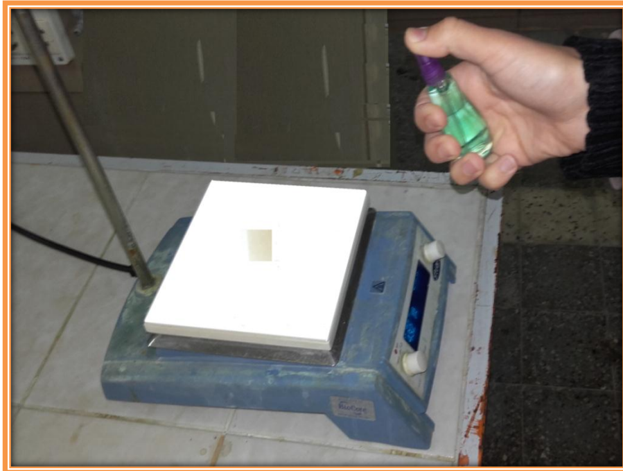
Figure II.1 : Dispositif expérimental de la technique de spray pyrolyse utilisé pour obtenir des couches minces (NiO).
