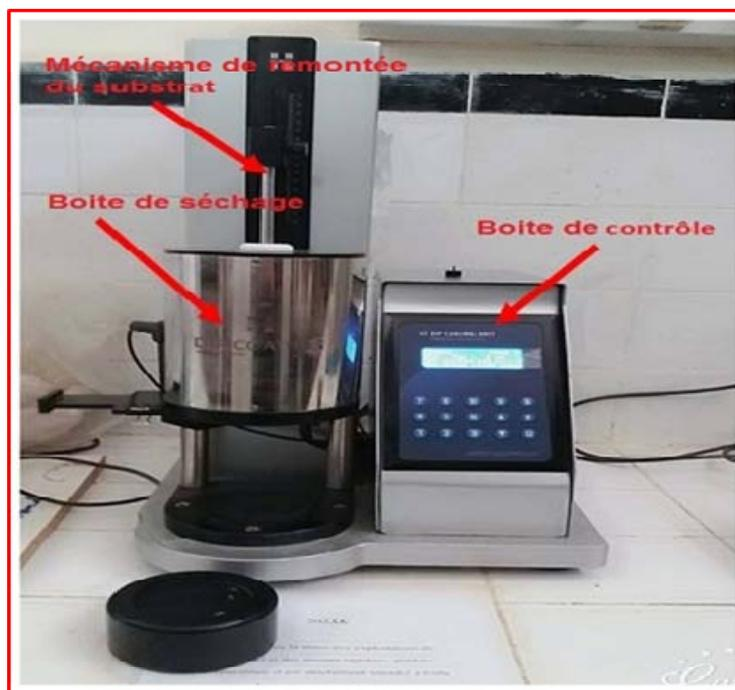
**Figure II.1.** Dispositif expérimental de tirage des couches utilisé au Laboratoire Couches Minces et Interfaces de l'Université de Constantine 1.
