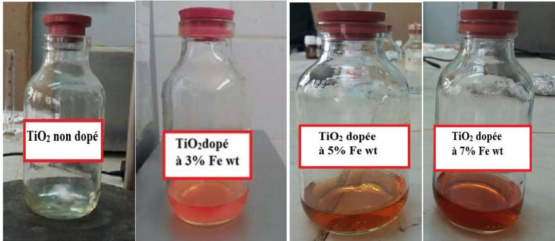
**Figure II.3.** Solution préparée par la voie *sol-gel* pour obtenir des couches minces de  $\text{TiO}_2$  dopé 0, 3, 5 et 7 % wt. Fe.
