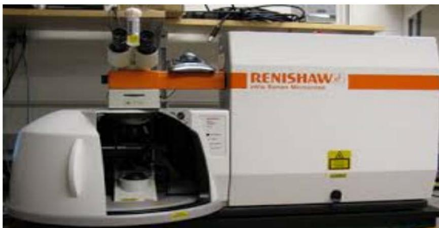
**Figure II.6.** Dispositif expérimental de la rétrodiffusion ( $\mu$ -Raman).
