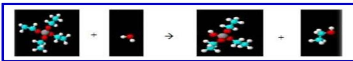
**Figure II.5 :** Schéma représentant la réaction chimique : hydrolyse (Gris : 'M', Blanc : 'H', Rouge : 'O', Bleu + blanc : 'R') [44].
