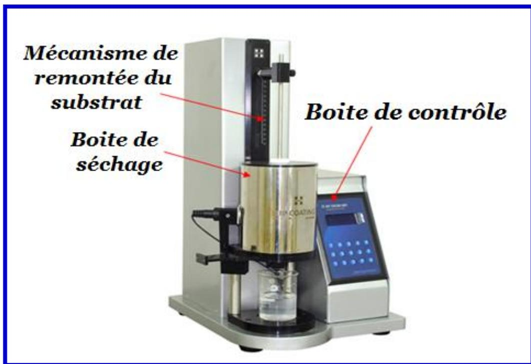
**Figure III.3 :** Dispositif expérimental de tirage des couches.
