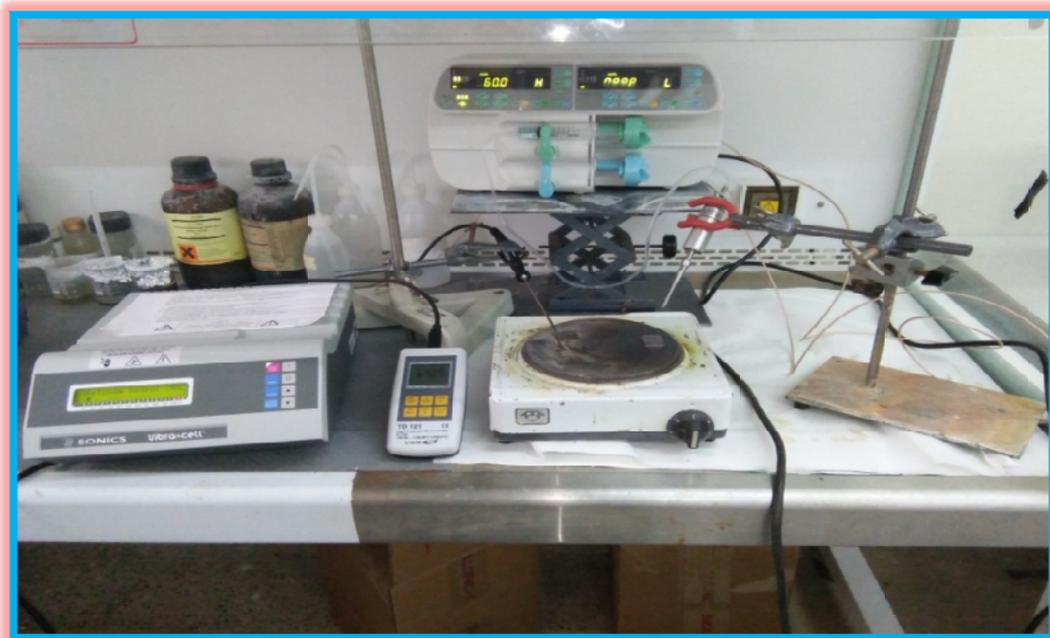
**Figure II.8.** La déposition de couches mince de  $\text{Cu}_x\text{O}:\text{Zn}$ .
