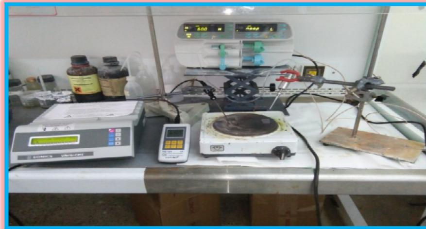
**Figure II.2.** Dispositif expérimental complet de la technique de spray pyrolyse ultrasonique.
