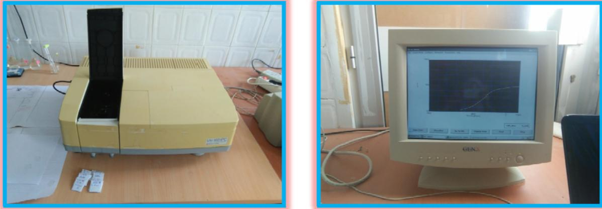
**Figure II.11:** Dispositif expérimental de la spectroscopie UV-visible.
