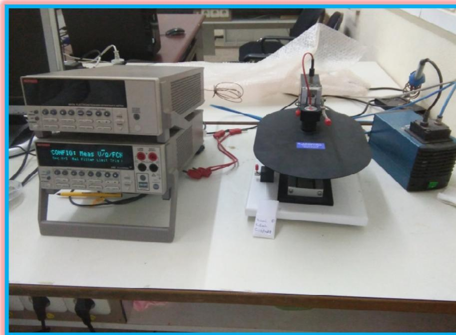
**Figure II.17.** *Dispositif de mesure de la conductivité de quatre pointes.*
