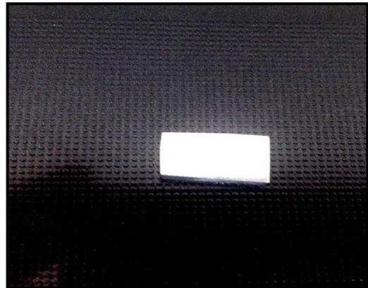
**Figure III.5** échantillon après polissage
