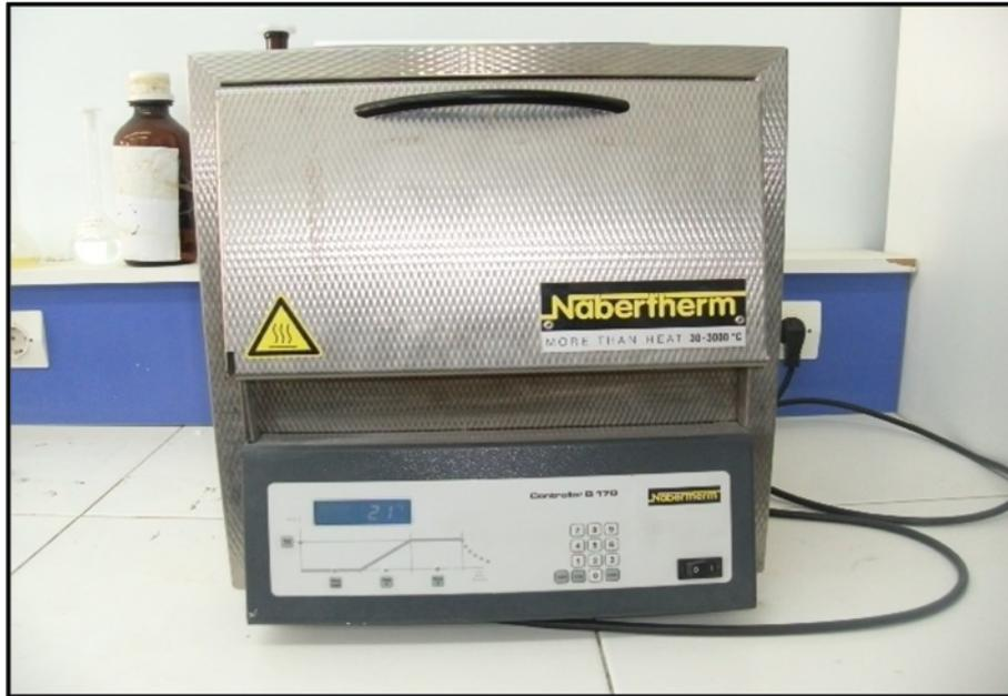
**Figure III.1:** Four de traitement thermique NABERTHERM.
