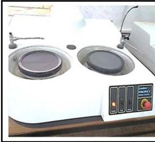
**Figure III.2 :** polisseuse mécanique (FORCIPOL 2).
