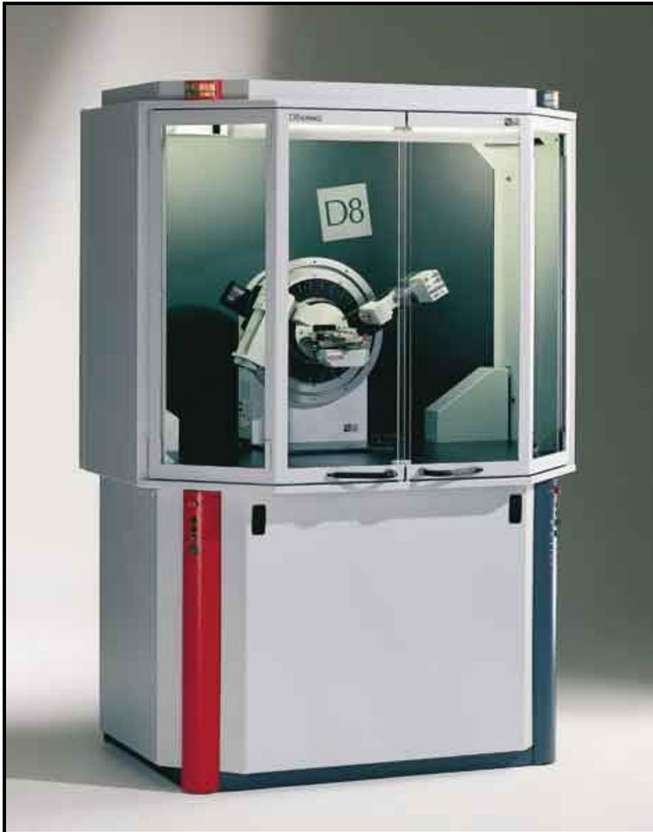
**Figure III.12 :** Diffractomètre BRUKER D8 ADVANCE.
