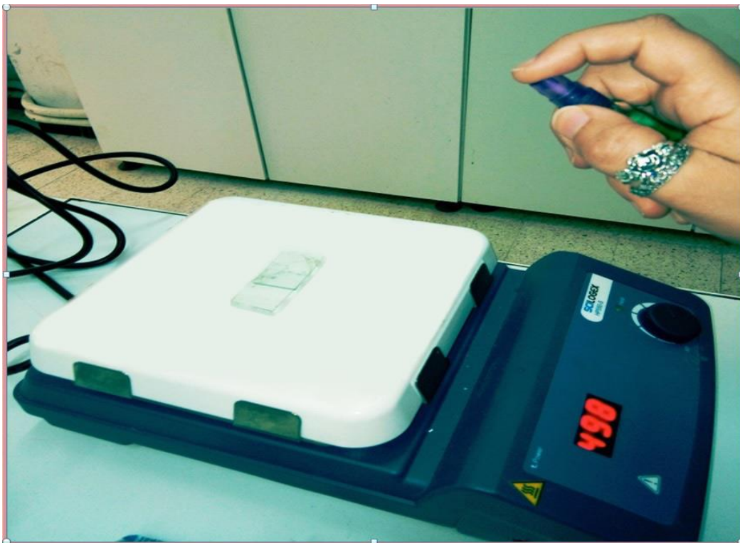
Figure II. 1. Dispositif expérimental de la technique utilisée pour élaborer nos couches minces (spray pyrolyse).
