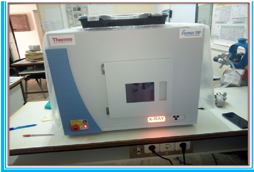
Figure II.5 : Photographie du diffractomètre de rayons X utilisée (EQUINOX 100). (laboratoire des matériaux et structure des systèmes électromécaniques et leur fiabilité Oum El –Bouaghie )
