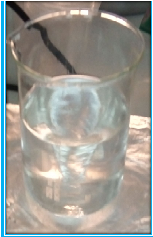
FigureII.3 : Apparence de laSolution utilisée(dissolution de l'acétate de zinc dans le méthanol après l'agitation magnétique).
