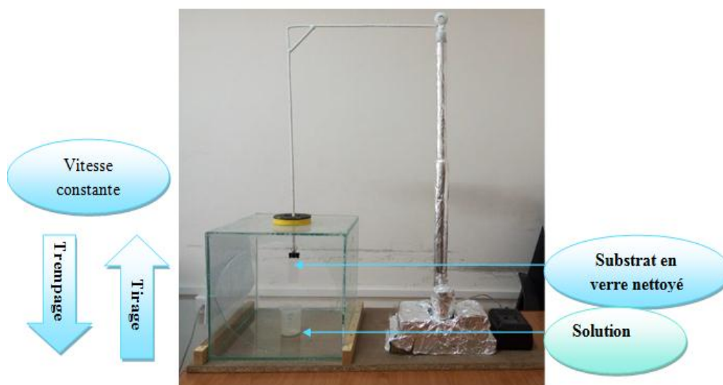
Figure II.4: Dispositif expérimental de la méthode Sol-gel dip coating utilisée.
