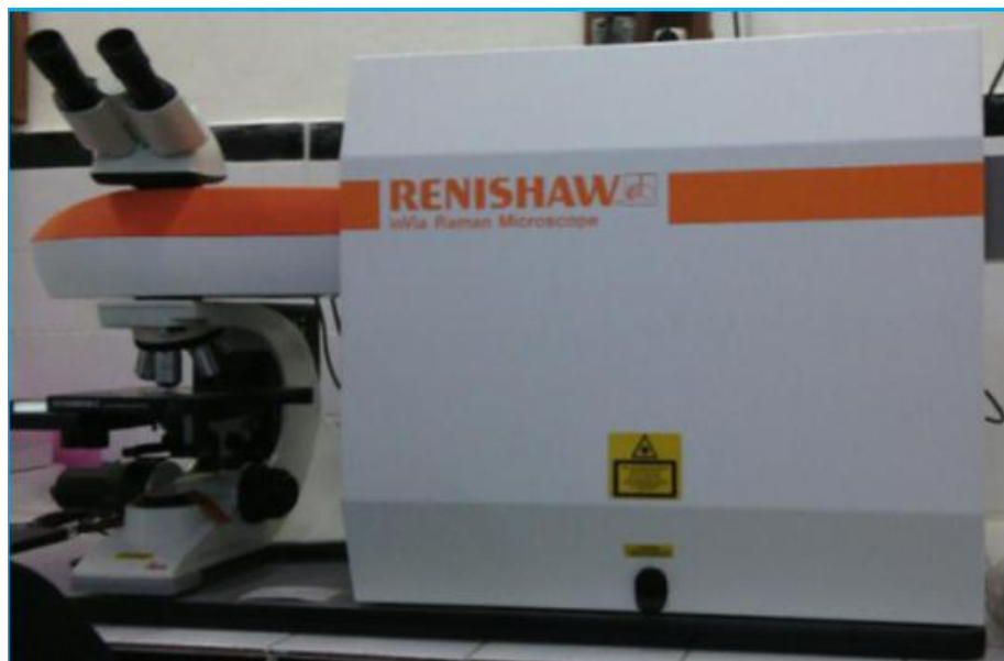
Figure II.9: Dispositif expérimental de la rétrodiffusion ( \mu -Raman).
