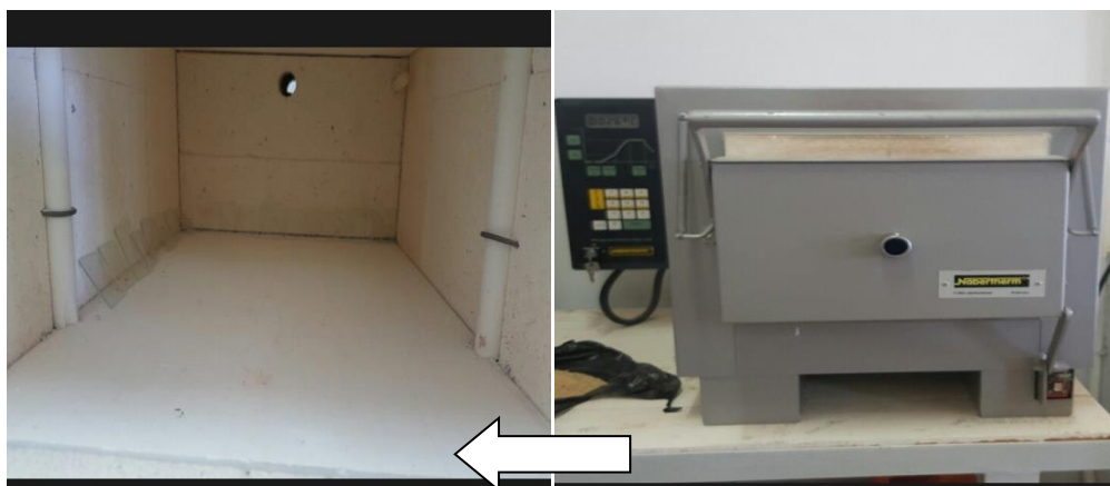
Figure II.5) : Une photographie du four utilisé de traitement thermique
