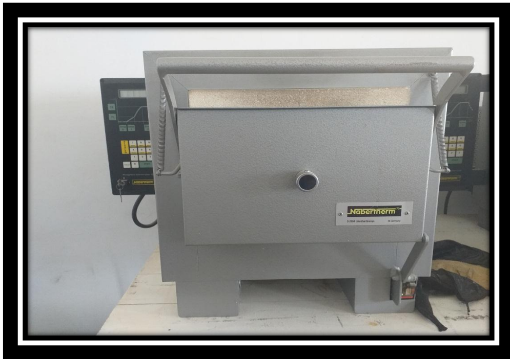
Figure II. 4: Une photographie du four pour le traitement thermique de nos échantillons, au Laboratoire de Traitement Thermique , Université Larbi Tébessi - Tébessa.
