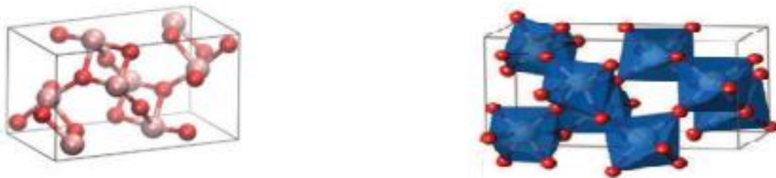
Figure I. 4: Représentation de la phase cristalline du \text{TiO}_2 Brookite (adapté de la référence [11]).
