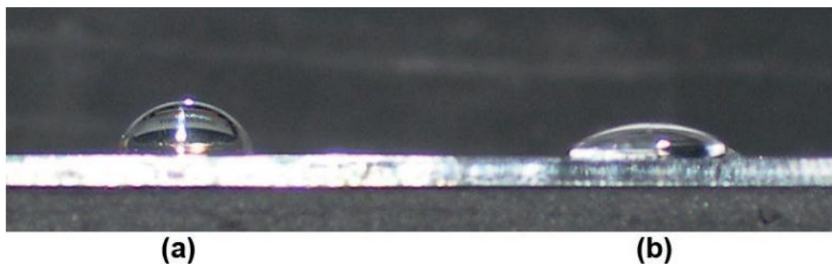
Figure I. 15: des gouttes d'eau sur la surface du film (a) et sur le substrat de verre surface (b) [7].
