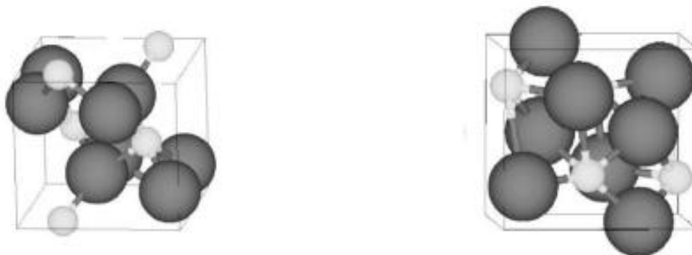
Figure I. 5: Phases cristallographiques du \text{TiO}_2 (a) colombite et (b) baddeleyite (adapté de la référence [15]).
