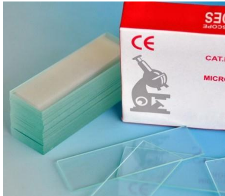
Figure II. 1: Lames de verre utilisés, avec épaisseur 1mm, taille 25 x 76 mm.
