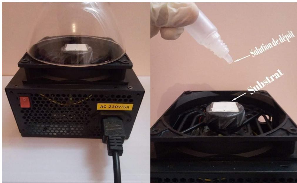
Figure II. 2: Dispositif expérimental de spin coating des couches utilisé au Laboratoire de physique appliquée et théorique, Université Larbi Tébessi - Tébessa.
