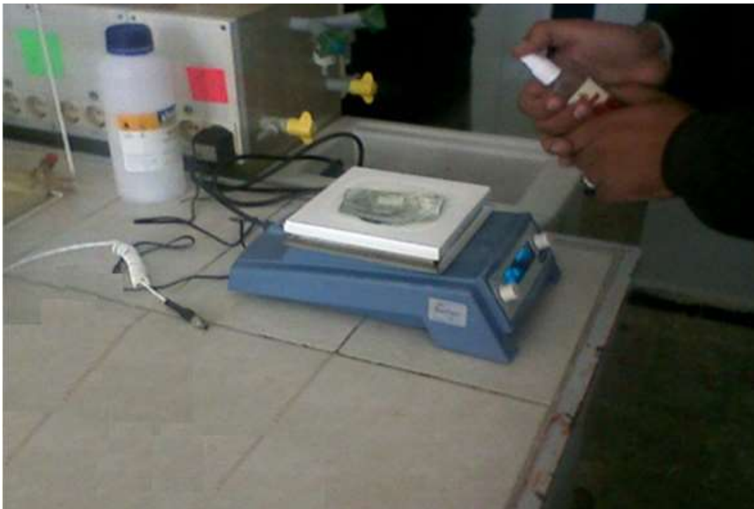
Figure II.2 : Le dispositif complet de la technique de spray pyrolyse utilisé pour obtenir nos couches minces de ZnO:In 2 O 3
