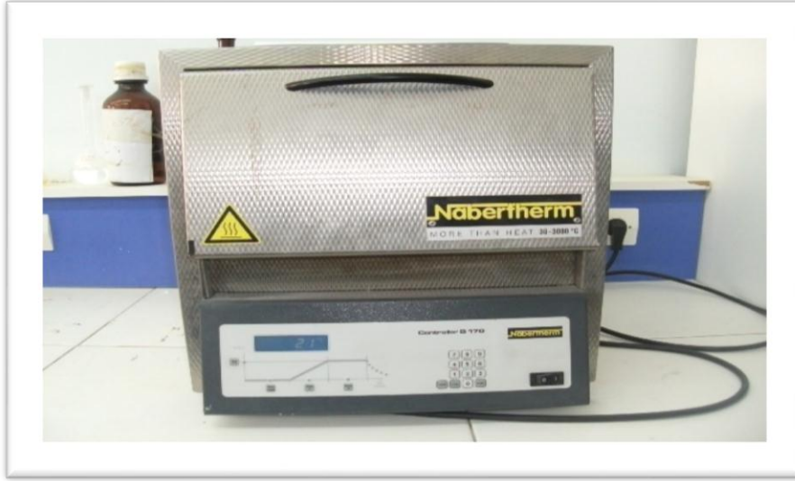
الشكل 17 . فرن المعالجات الحرارية نابيرثرم NABERTHERM.
