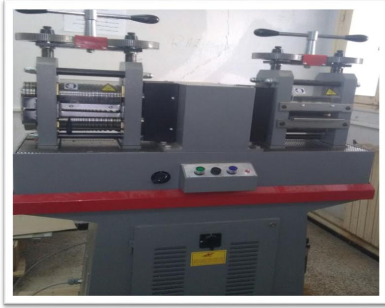
الشكل 18. يوضح ماكينة الدرفلة (مختبر العناصر النشطة والمواد بجامعة العربي بن مهدي أم البواقي).
