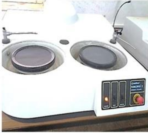
الشكل III.2: الورق الكاشط و ماكينة الصقل الميكانيكي (FORCIPOL 2).
